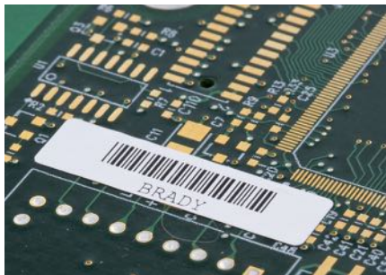
Etiquetas de componentes eléctricos
